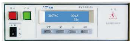
单相泄漏电流测试仪
